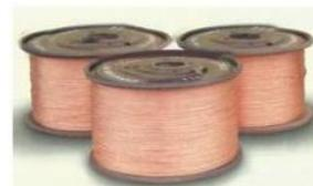
Figura 2 - bobine di filo di rame dopo la fase di avvolgimento
