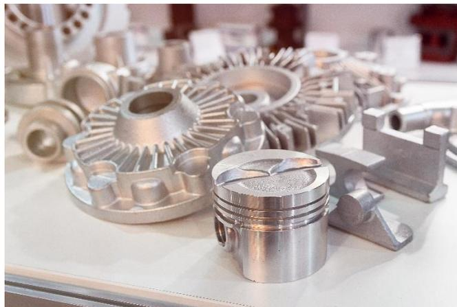
Figura 1 – Esempio di prodotti sinterizzati
